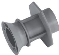
OKTAGON®-PLUS Konus 22 aus Kunststoff für die Selbsterstellung von wasserdichten Spannstellen. Durch Ablängen eines Kunststoffrohres 22/26mm um 8cm kürzer als die gewünschte Wandstärke und Aufpressen von Konen, können Längen mit den Eigenschaften von OKTAGON®-PLUS 22 hergestellt werden.
