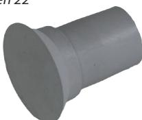
OKTAGON®-PLUS Sichtbetonstopfen 22 aus Kunststoff für das einfache Verschließen der Spannstelle. Nur einschlagen, nicht kleben! Schattenfuge ca. 2mm.
