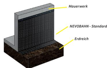
**Einsatz bei Grundmauerschutz**
