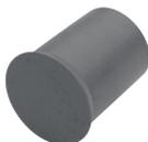
OKTAGON® Stopfen 22 für das dichte Verschließen von OKTAGON®-PLUS Konus 22. Nur einschlagen, nicht kleben! Durch den langen Stopfen einfache und schnelle Arbeitsweise. Die massive Ausführung des Stopfens erhöht die Sicherheit des Systems. Einbautiefe ca. 12mm.
