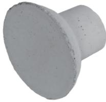
Vorgefertigter Kegel in hochwertiger Sichtbetonqualität zum Verschluss von Spannstellen. Passend zu K22. Nach dem Entfernen des Konens wird der Sichtbetonkegel in die konische Öffnung eingeklebt. Es ergibt sich eine kleine Schattenfuge.
