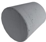
Vorgefertigter Kegel in hochwertiger Sichtbetonqualität zum Verschluss von Spannstellen. Nach dem Entfernen des Konens K22/5 wird der Sichtbetonkegel in die konische Öffnung eingeklebt. Der Kegel ist etwas kürzer als die konische Öffnung, dadurch wird die Ausbildung einer Schattenfuge erreicht.
