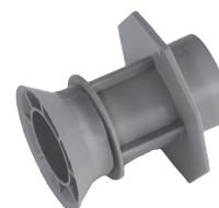
OKTAGON®-PLUS Stopfen 26 für das dichte Verschließen von OKTAGON®-PLUS Konus 26. Nur einschlagen, nicht kleben! Durch den langen Stopfen einfache und schnelle Arbeitsweise. Die massive Ausführung des Stopfens erhöht die Sicherheit des Systems. Einbautiefe ca. 12mm.
