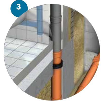
ROHRDURCHFÜHRUNG: BODENPLATTE > HKD® Bauherrenpaket
