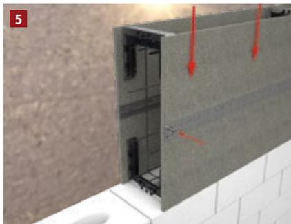
Die obere MBA® Ringbalkenschalung wird um 180° gedreht, stoßversetzt mit den Schenkeln in die Öffnungen der Erhöhpprofile gestellt und verschraubt.
