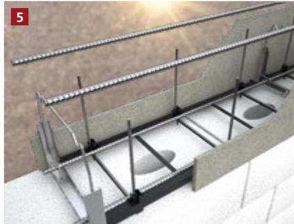
Die Stabstähle werden oben in die vorgegebenen Aufnahmen der Steckbügel eingelegt.
