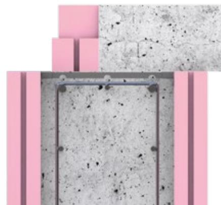
\* Typ = H = Dämmstoffstärke (+ 10 cm Holzbeton)
