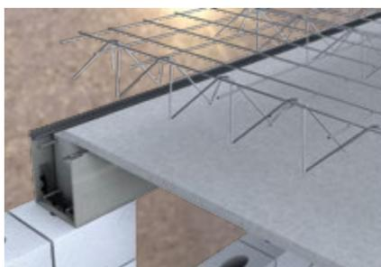
2. Nachdem die Schalung ausbetoniert ist, wird die Filigrandecke aufgesetzt und die Bewehrung ausgelegt. Durch diese Vorgehensweise können Sturz und Decke mit einer Schalung ausbetoniert werden, ohne dass der erhöhte Außenschenkel beim Einlegen der Bewehrung hinderlich ist.
