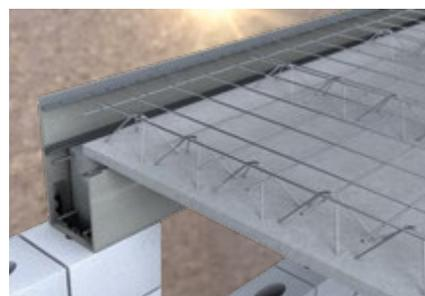
3. Sobald die Bewehrung ausliegt, wird die Schenkelerhöhung in das Erhöhungsprofil eingesetzt und verschraubt. Nach Rückverankerung zur Filigrandecke kann die Decke ausbetoniert werden.
