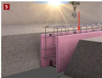
Die Bewehrung wird einfach in die Schalung eingesetzt.
