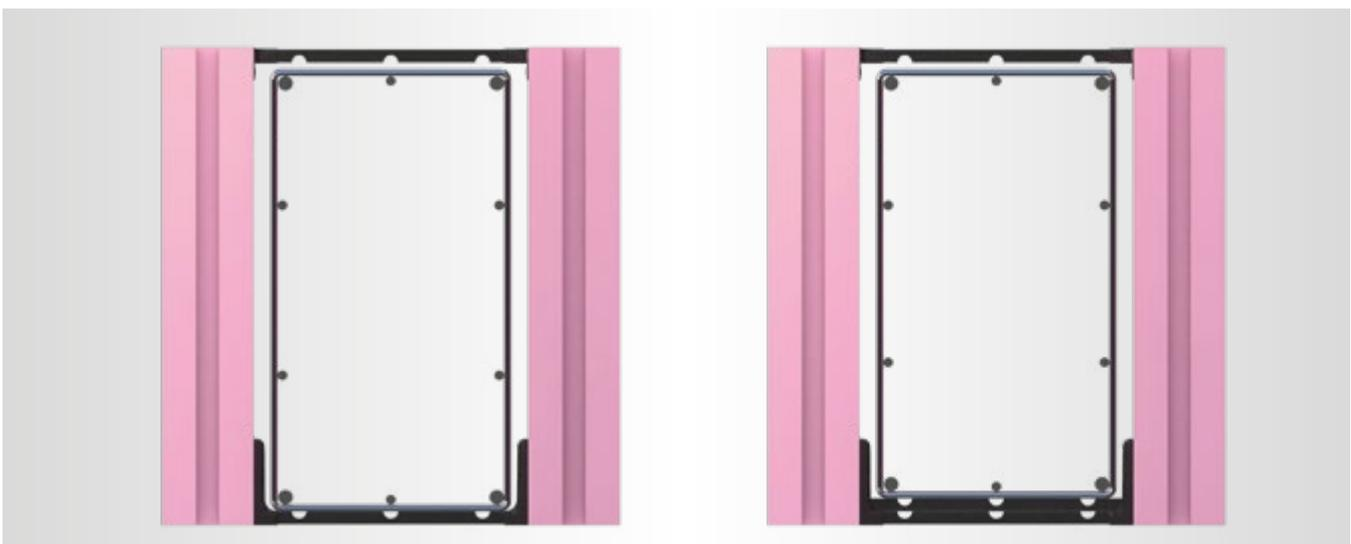
Die Aufnahmewinkel und das Stecksystem dienen durch ihre Vollkunststoff-Bauweise dabei als ideale Hilfe zur Bewehrungspositionierung mit einer Betondeckung von wahlweise 20 oder 40 mm unterhalb der Bewehrung und 35 mm seitlich.
