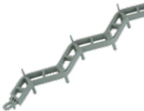
Abstandhalter für leichte Bewehrung mit sehr gutem Betondurchfluss. Durch spezielle Füße geringer Kontakt zur Schalung. Nach oben stehende Noppen verhindern das Verrutschen der Bewehrung. Lieferung auch ohne Noppen möglich. Durch Steckkupplung beliebig zu verlängern.
