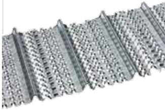
Rippenstreckmetall wurde speziell für den Betonbau entwickelt. Es besteht aus feuerverzinktem Stahlblech und wird als verlorene Schalung eingesetzt. Durch eine Rippenhöhe von ca. 21mm und eine besondere Profilierung ist dieses extrem stabil und sichert einen perfekten Verbund von Arbeitsfugen.
