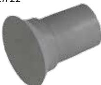
OKTAGON®-PLUS Sichtbetonstopfen 22 aus Kunststoff für das einfache Verschließen der Spannstelle. Nur einschlagen, nicht kleben! Schattenfuge ca. 2mm.
