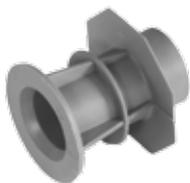
Vorsatzkonus OKTAGON® Konus für die Selbsterstellung von wasserdichten Schalungsspannstellen. Durch Ablängen eines Kunststoffrohres 22/26mm um 8cm kürzer als die gewünschte Wandstärke und Aufpressen eines OKTAGON® Konus, können Sonderlängen mit den Eigenschaften von OKTAGON® hergestellt werden.
