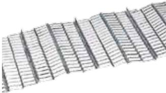
Putzträgerplatte aus verzinktem Stahlblech. Durch enge Maschen wird eine bessere Putzverankerung gewährleistet. Durch die 8mm hohen Rippen sehr robust und widerstandsfähig, trotzdem leicht verformbar. Sehr anpassungsfähig an alle geometrischen Formen.
