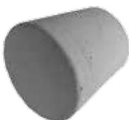
Vorgefertigter Kegel in hochwertiger Sichtbetonqualität zum Verschluss von Spannstellen. Nach dem Entfernen des Konus K22/5 wird der Sichtbetonkegel in die konische Öffnung eingeklebt. Der Kegel ist etwas kürzer als die konische Öffnung, dadurch wird die Ausbildung einer Schattenfuge erreicht.
