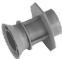
OKTAGON®-PLUS Konus 22 aus Kunststoff für die Selbsterstellung von wasserdichten Spannstellen. Durch Ablängen eines Kunststoffrohres 22/26mm um 8cm kürzer als die gewünschte Wandstärke und Aufpressen des Konus, können Längen mit den Eigenschaften von OKTAGON®-PLUS 22 hergestellt werden.
