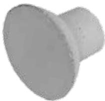
Vorgefertigter Kegel in hochwertiger Sichtbetonqualität zum Verschluss von Spannstellen. Passend zu K22. Nach dem Entfernen des Konus wird der Sichtbetonkegel in die konische Öffnung eingeklebt. Es ergibt sich eine kleine Schattenfuge.
