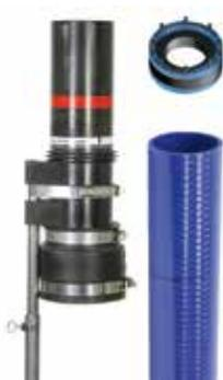
Variante: Quadro-Sicura® ADS Rohbauteil mit biegefestem Mantelrohr (ID 110 mm) und Dichtungssystem Curaflex Nova® für Leitungsdurchmesser bis max. 63 mm. Weitere Ausführungen auf Anfrage.
