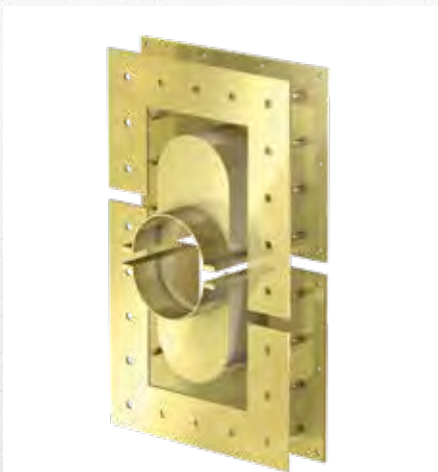
OBJEKT // Abdichtung für Wanddurchführungen von Versorgungsleitungen. Besondere Anforderung: Erhaltung der vorhandenen Bausubstanz trotz umfassender Sanierung der Leitungen. Konstruiert und gefertigt für die Sanierung/ den Umbau eines denkmalgeschützten Wohngebäudes.
