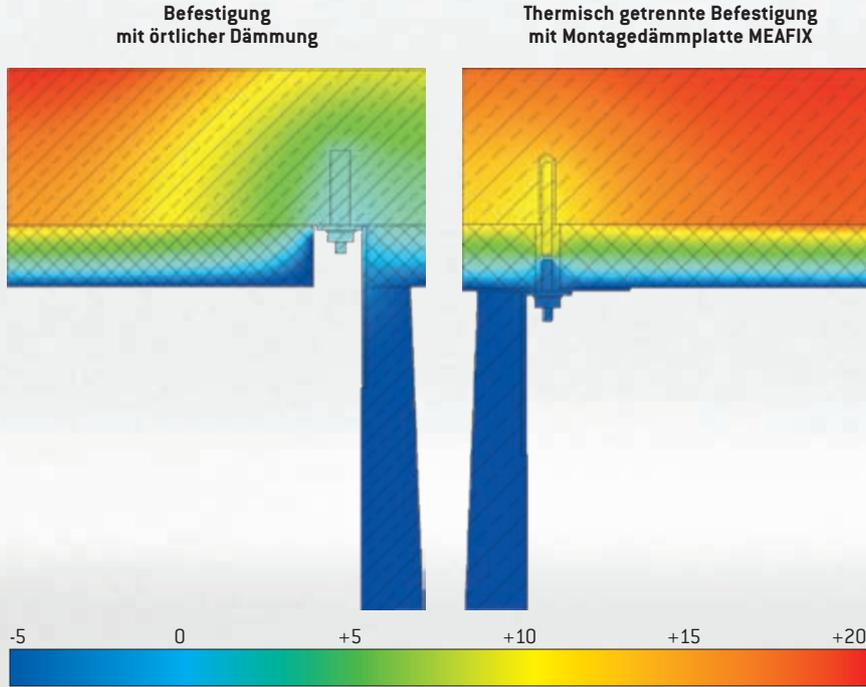
Direkter Vergleich des Temperaturverlaufs. Temperaturangaben in °C.
