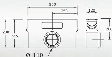
MEAGARD II S/M Einlaufkasten (Abmessungen in mm)
