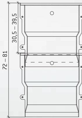
Verstellbereich bei Aufsatz mit Befestigungsösen
